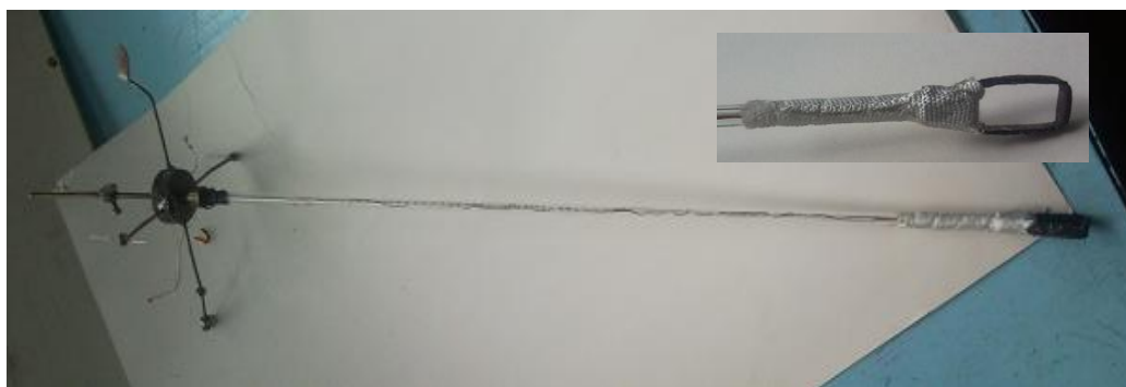
Рис. 2. Маятник с контейнером для размещения образцов.
