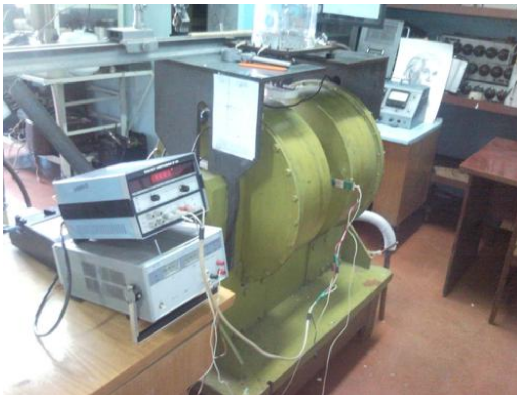
Рис. 1. Экспериментальная установка для исследования магнитной восприимчивости по методу Доменикали.
